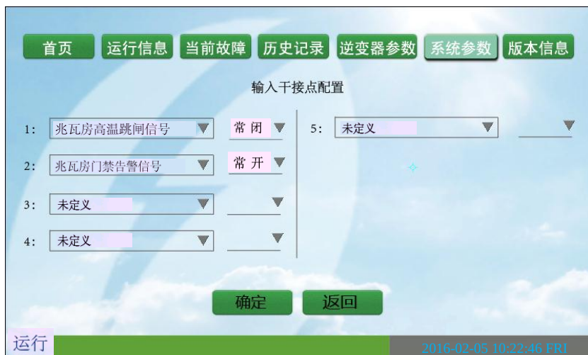
图 5-9 兆瓦房告警配置
